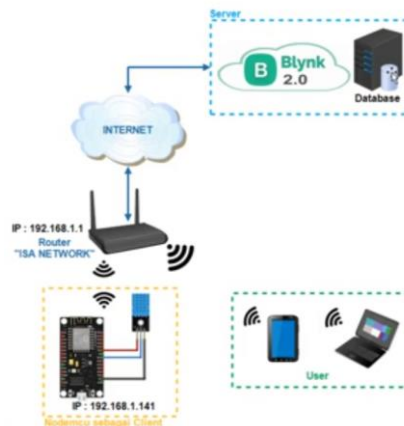
Gambar 5. Desain sistem monitoring suhu dan kelembaban udara (Mahfudi, 2022)
