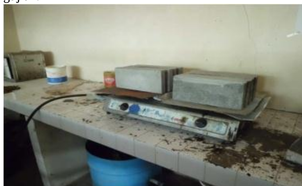
Gambar 3. Proses Pengovenan Pengujian Densitas dan Penyerapan Air
