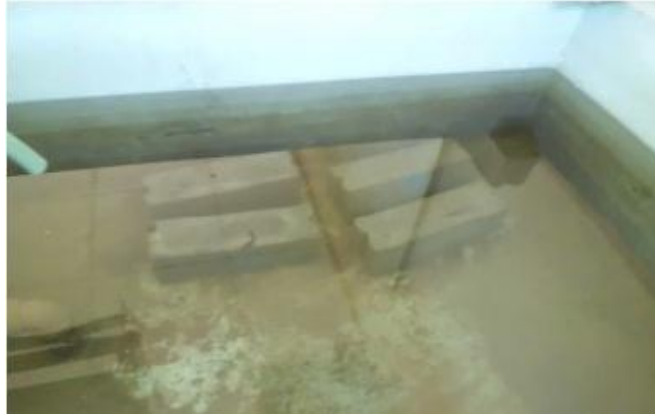
Gambar 4. Proses Perendaman Pengujian Densitas dan Penyerapan Air
